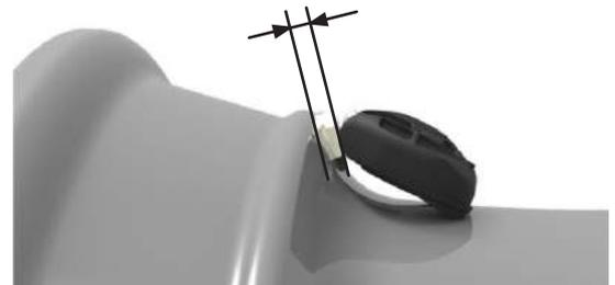
⑤ Den Sensor gegen die Felge drücken und halten, wie im vorherigen Bild gezeigt. Die T30-Schraube mit einem kalibrierten Drehmomentschraubendreher mit 6.0 Nm  $\pm$ 0.5 Nm festziehen.
