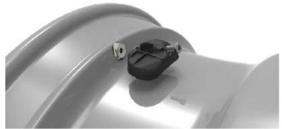
③ Den Sensor auf der Innenseite der Felge auf den Ventilkopf setzen und mit der Schraube so fixieren, dass der Sensor noch leicht bewegt werden kann.
