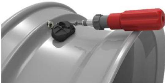
④ Den Sensor gegen die Felge drücken und halten, sodass dieser am Felgenbett aufliegt. Der Ventilkopf muss über eine eventuelle Senkung hinausragen, damit zwischen der Vorderseite des Sensors und der Felge ein Abstand besteht.
